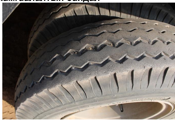
Зураг №12 Замын-Үүд сумын “Замын-Үүд НААҮ ОНӨ ХХК-нд хог тээврийн 2 ширхэг автомашин худалдан авах” автомашины дугуй муудаж тросс нь гарсан байна. /2022.05.18-ны өдрийн байдлаар/
